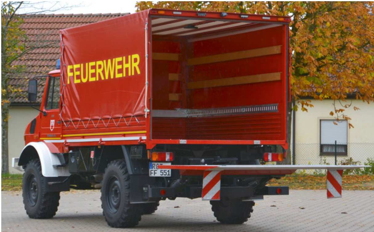
Abbildung 7 Ein Unimog U1300L als GW-L1 nach Umbau. Quelle: Alexander Müller, Feuerwehrmagazin, Ausgabe 02/23
